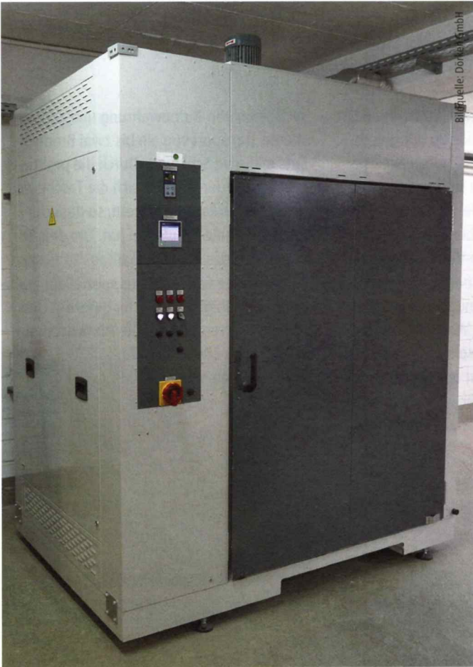
Der Alterungssofen erzeugt eine Luftgeschwindigkeit von 5 m/s. DDH, Steildach, Unterspannbahn.
