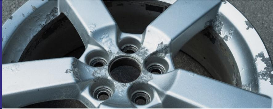
Die Prüfung nach Filiform bezieht sich in der Regel auf einen spezifischen Test zur Beurteilung der Filiformkorrosion auf beschichteten Metalloberflächen, wie beispielweise Aluminium und dessen Legierungen.
