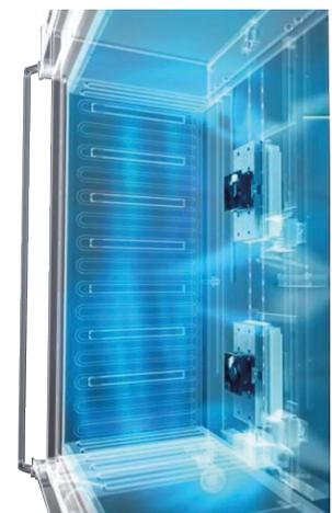
**Blick in die Memmert Konstantklima-Kammer HPPeco: Beim Heizen wird der Umgebung Energie entzogen und in die Kammer übertragen. Zum Kühlen wird die Polarität des Halbleiters umgekehrt und dem Innenraum die Energie entzogen.**
