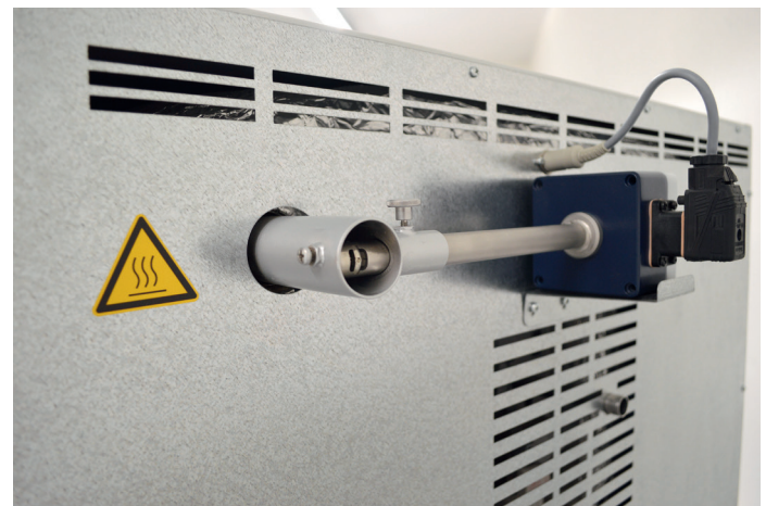
Anemometer zum Messen der Luftwechselrate
