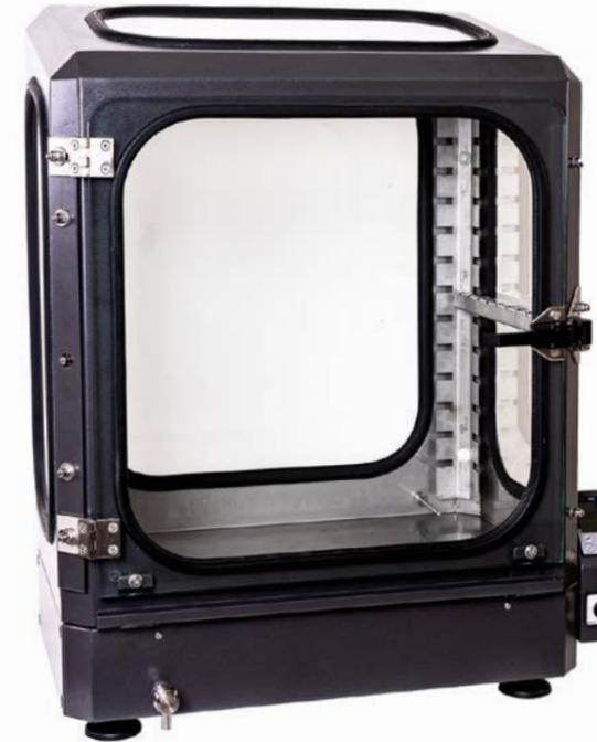
Durch die Beanspruchung der Proben mit Kondenswasser wird die Beständigkeit von Beschichtungsstoffen gegen Feuchtigkeit ermittelt. Bei dieser einfachen aber sehr wirksamen Qualitätsprüfung wird eine permanente Betauung am Prüfling erzeugt. Der optionale Einsatz von Schwefeldioxid ermöglicht einen Testlauf für höhere Beanspruchungen (Kesternichtest).
