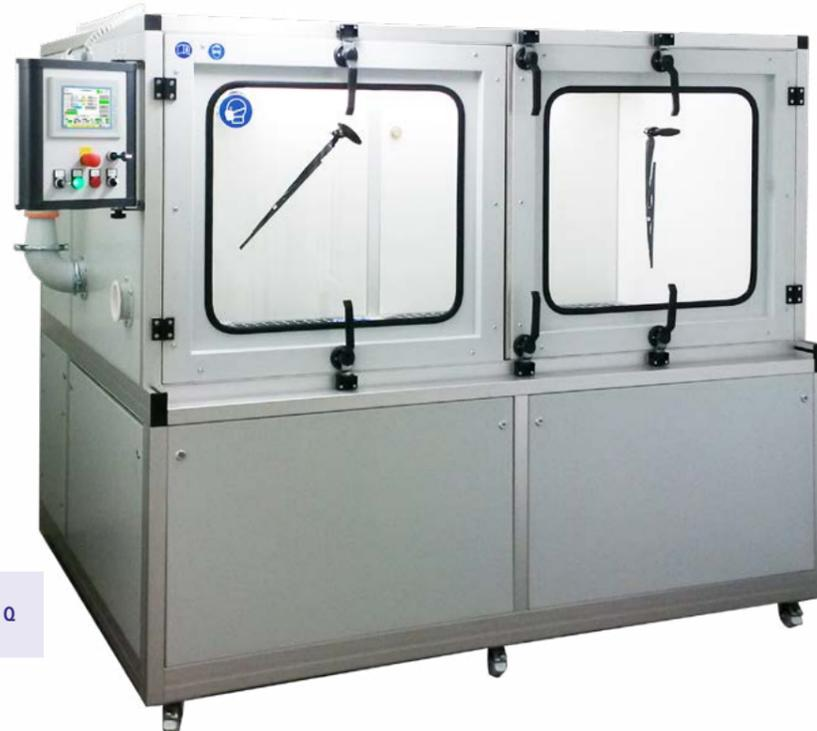
IP 5X und 6X mit Unterdruckeinrichtung
