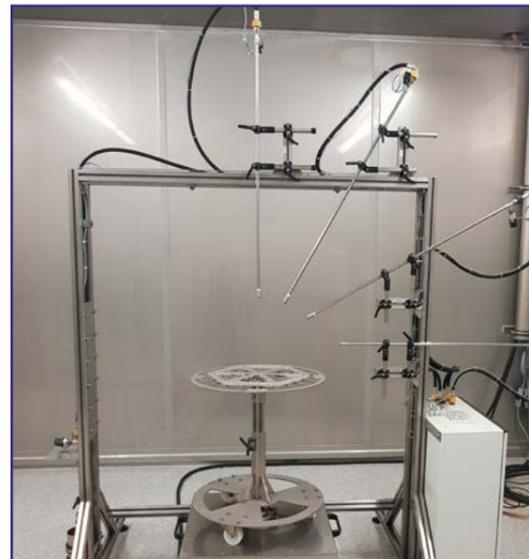
IP X9K Prüfung mit Flachdüse
