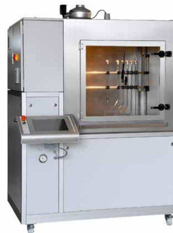
Die Beständigkeit eines beschichteten Prüflings gegen den Verlust der Haltfestigkeit wird mit einem definierten Druckwasserstrahl geprüft. Die Durchführung erfolgt nach der Prüfnorm DIN EN ISO 16925.
