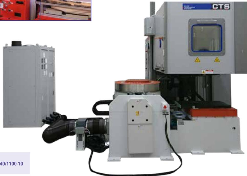
Klima-Vibrationsprüfschrank CV -40/1100-10
