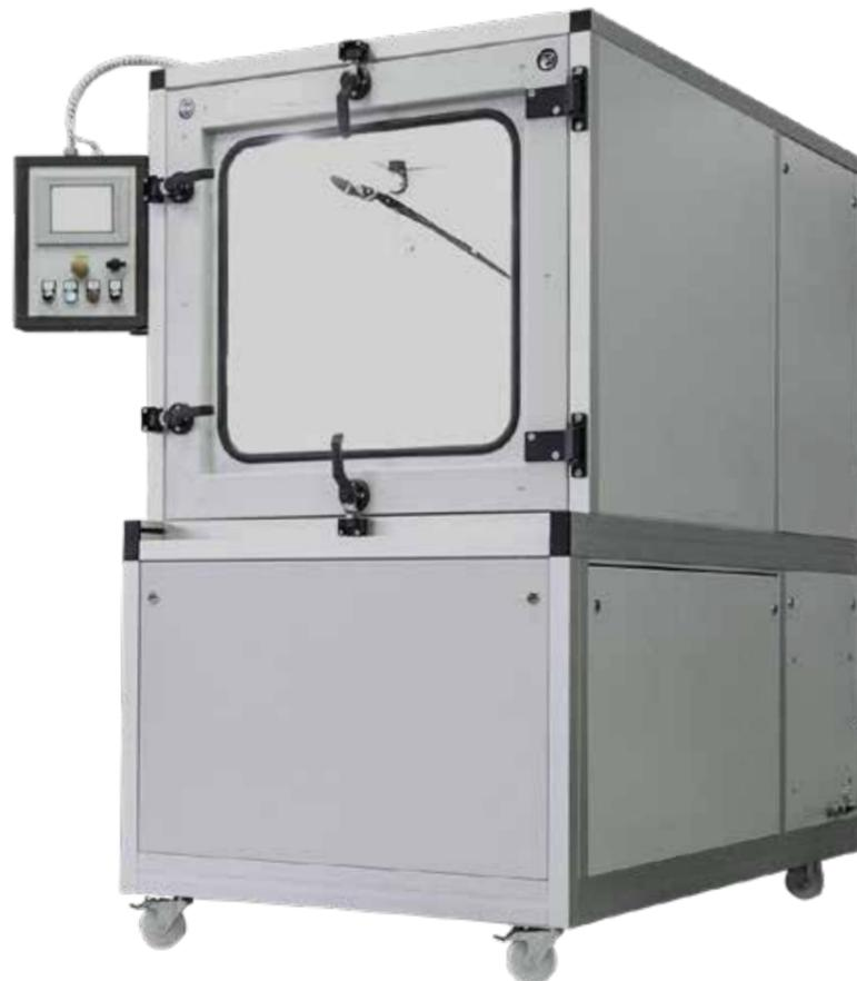
Staubtestkammer 2000 l
