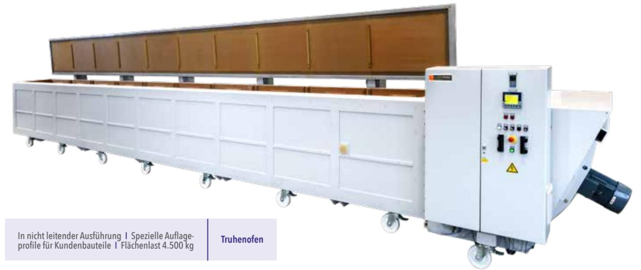
In nicht leitender Ausführung | Spezielle Auflageprofile für Kundenbauteile | Flächenlast 4.500 kg
