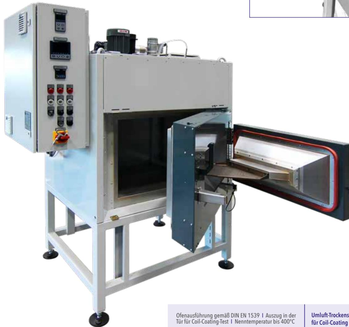
Ofenausführung gemäß DIN EN 1539 | Auszug in der Tür für Coil-Coating-Test | Nenntemperatur bis 400°C
