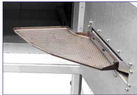
Coil Coating (Bandbeschichtung) ist ein Beschichtungsverfahren, bei dem Bleche aus Stahl, Edelstahl oder Aluminium kontinuierlich mit Lacken oder Folien, einseitig oder beidseitig beschichtet und anschließend ausgehärtet werden. Um dieses Trocknungsverfahren simulieren zu können, eignen sich unsere Coil-Coating-Öfen.
