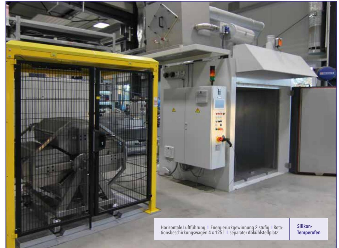
Horizontale Luftführung | Energierückgewinnung 2-stufig | Rotationsbeschickungswagen 4 x 125 l | separater Abkühlstellplatz
