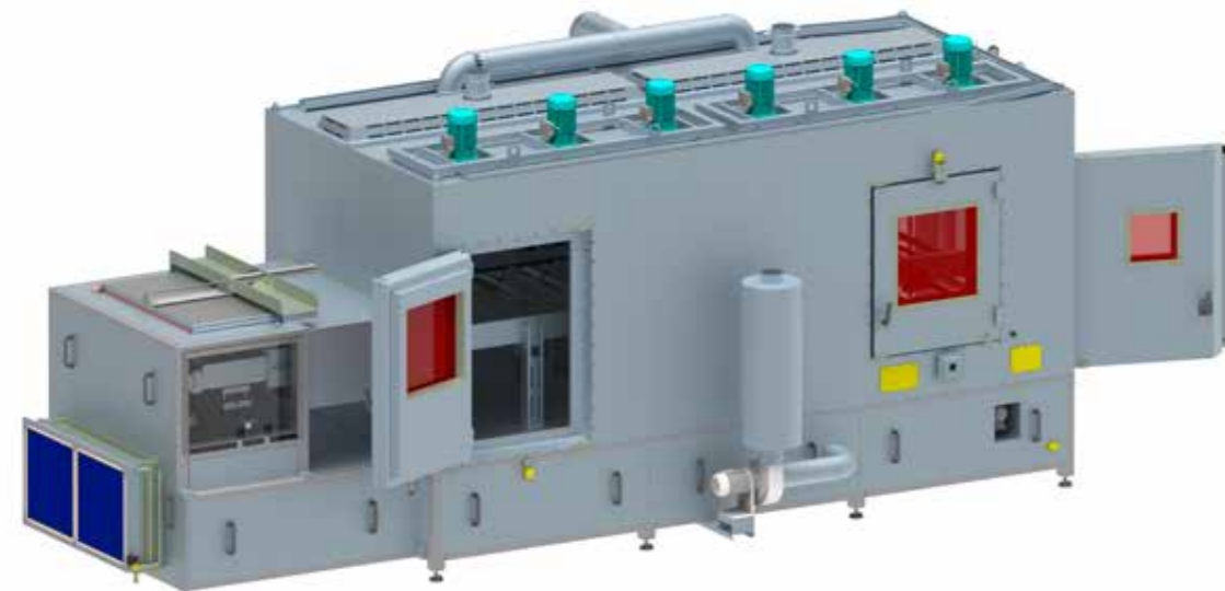
Kühlzone unterhalb der Heizzone geführt (platzsparende Variante) | kundenseitige Sensor-Prüfstation in Ofenkammer mit extrem hoher Temperaturstabilität | Be- und Entladebereich
