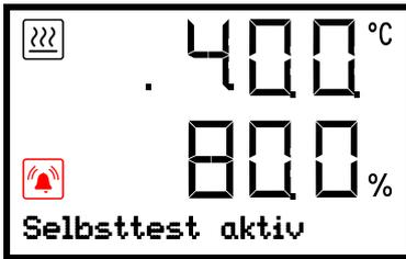
Anzeige des laufenden Selbsttests in der Normalanzeige
