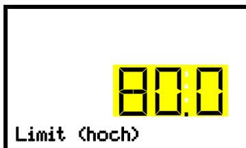
Einstellung des Überwachungsregler-Grenzwertes „Limit (hoch)“ für im Überwachungsregler-Modus „Limit“.
