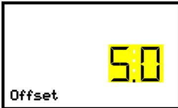
Einstellung des Überwachungsregler-Offsetwertes für Über- und Untertemperatur im Überwachungsregler-Modus „Offset“
