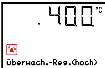
Alarmanzeige (Beispiel: Übertemperatur-Überwachungsregler-Alarm)
