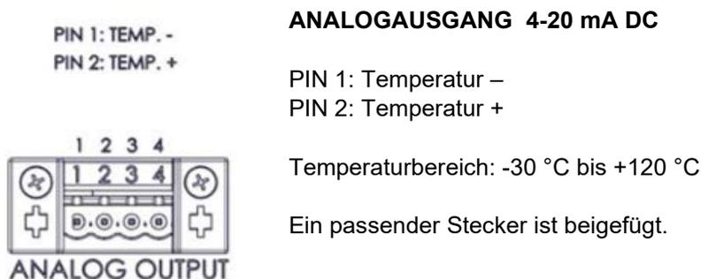
Abbildung 14: Pinbelegung der Buchse „ANALOG OUTPUT“ (I) für Option Analogausgänge
